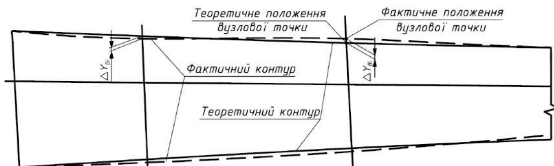
Рис.2 Розташування фактичних вузлових точок виготовленого ізольованого крила у недеформованому стані
