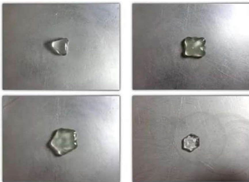
Рис. 1. Варіанти форм поверхні краплі води під час ефекту Лейденфроста
