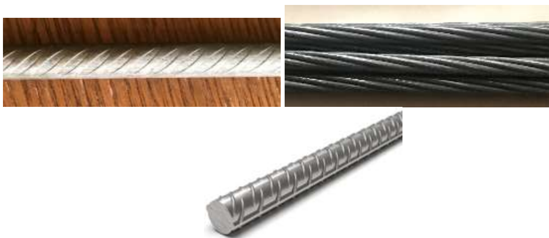
Рисунок 1. Применяемая в изготовлении железобетонных изделий стальная арматура периодического профиля и канаты
