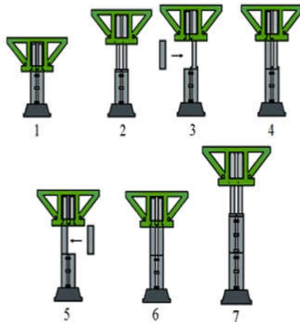
Рис. 2. Моделювання піднімання покриття з використанням ВІВМ: 1 – початковий стан ВІВМ, 2 – початок циклу підйомника ВІВМ, 3 – забирання першого штоку підйомника ВІВМ, 4 – встановлення та закріплення першої частини колони, підтискання першим штоком першої частини колони, 5 – забирання другого штоку підйомника ВІВМ, 6 – встановлення та закріплення другої частини колони, підтискання другим штоком другої частини колони, 7 – початок наступного циклу робіт підйомника ВІВМ.
